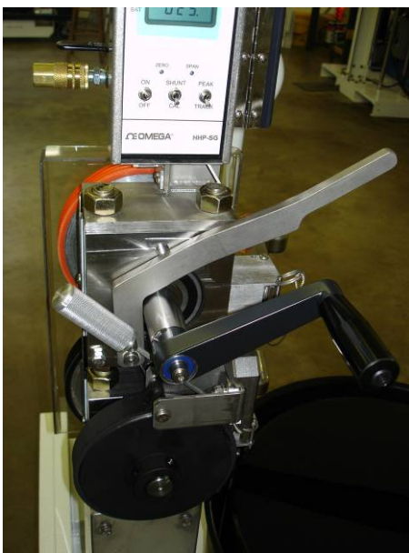
Levier de charge débrayé et manivelle embrayée
